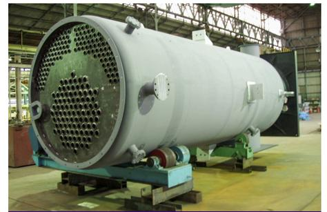
排ガス煙管式縦型温水ボイラー
